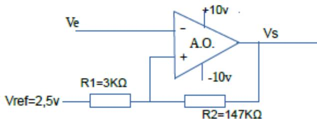
a) Si:  $V_- = V_e < -5V$ , el operacional en configuración de comparador proporciona una tensión de salida  $V_s = 10V$
